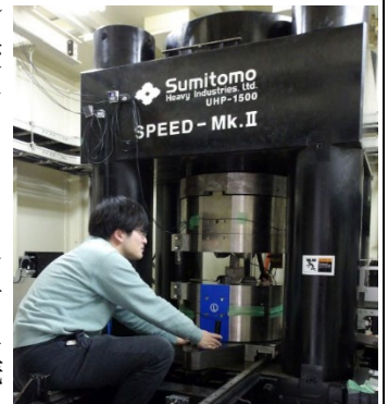
図：SPring-8 に設置されている D-DIA 型変形装置
